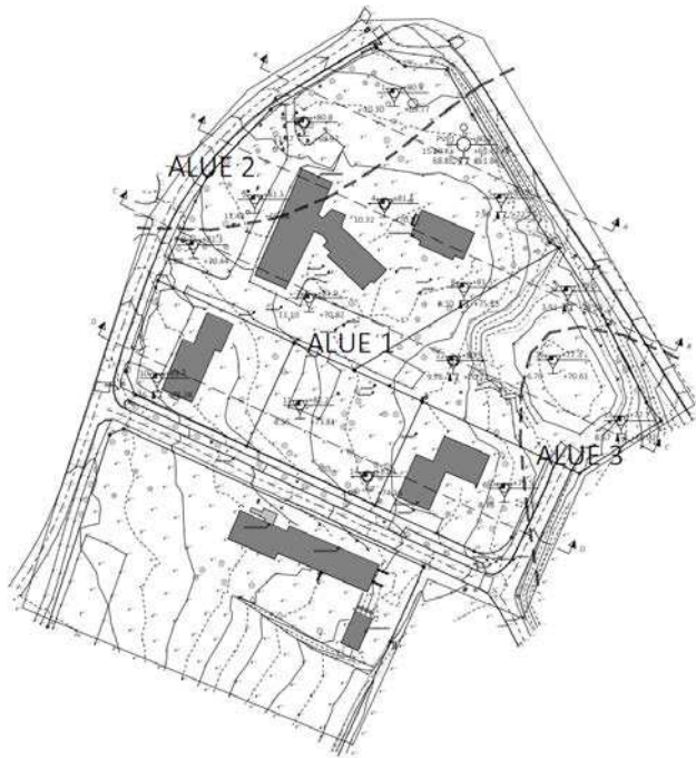
Kuva 5 Rakennettavuusselvitys, pintavaaitus- ja pohjatutkimusasemapiirros. Taratest Oy.
